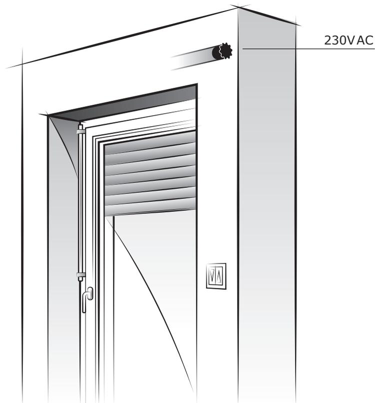
Sonnenschutzprodukte mit der Ausstattung 230V-Antrieb mit Gurtgetriebe und Gurt sind im Markt verfügbar für Rollläden und Fassadenmarkisen. Bei einem Stromausfall oder Defekt des Motors kann das Hochfahren über den Gurt erfolgen. Gegenüber reinen Motoranlagen gibt es hier Einschränkungen in der maximalen Baugröße des Sonnenschutzproduktes, je nach Ausführung ist bei den Motoren mit abweichenden Laufeigenschaften gegenüber Standardantrieben zu rechnen.
