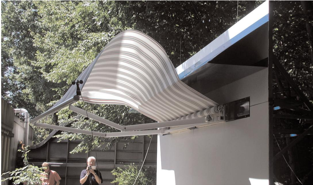
Abbildung 3: Verhalten der Markise in der Windkanalprüfung
