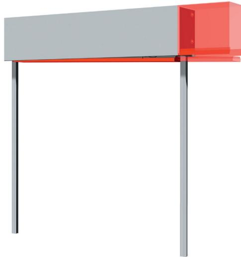
*Bild 16: Veränderte Endlagenposition der Unterschiene (Unterschiene schief),
