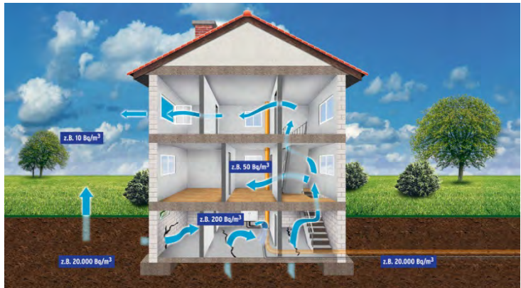
Abbildung 9: Weg des Radons in Gebäuden, Grafik: © Bundesamt für Strahlenschutz Deutschland
