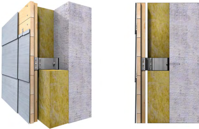
Abbildung 22: Aufbau einer hinterlüfteten Fassade | © RHEINZINK www.rheinzink.de
