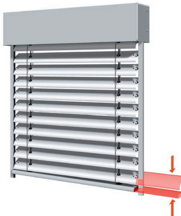
Bild 8: Lage der Unterschiene im abgefahrenen Zustand
